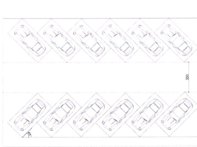
ŞEKİL-3 45°lik park için araçlar arası min mesafe 3.50 m
